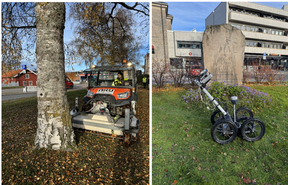
Figur 7: Motorisert, 16-kanals georadar (t.v.) og manuell, enkeltkanals georadar (t.h.) under datainnsamling i Triangelparken. Bildene er tatt hhv. mot NV og N. Foto: JC/NIKU
